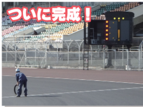
⑧ 11月1日、大時計を稼働させ、各ハンデ位置にタイヤを乗せてフライング・センサーのテストを実施しました。
