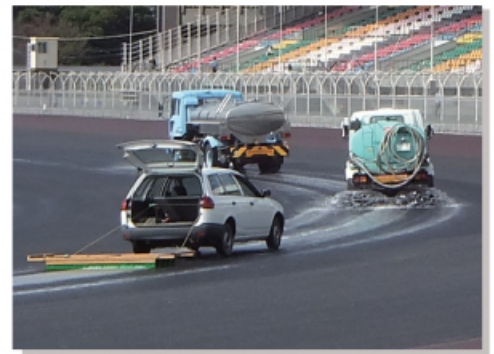
⑥ 10月下旬、競走路の表面に浮いてくる油膜を、日数をかけて念入りに除去清掃。スリップを減らし接地感を高めます。
